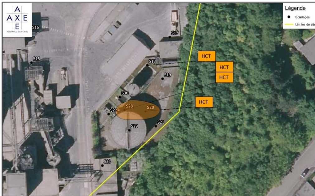
Figure 57 : Entendue de la pollution au droit de l'ancienne cuve de fioul lourd
